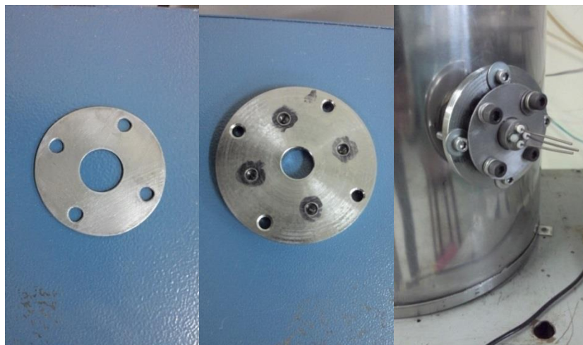
Flange superior; Flange inferior; Montagem do conjunto no reator.
