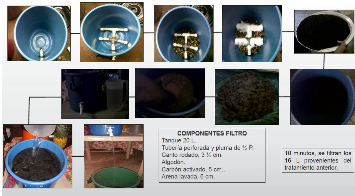
Figura 2: Construcción del sistema de filtración
