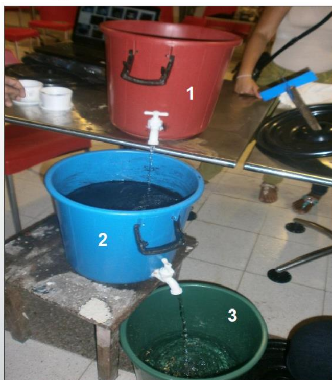
Figura 5: Prototipo de planta potabilizadora, puesto en operación.
