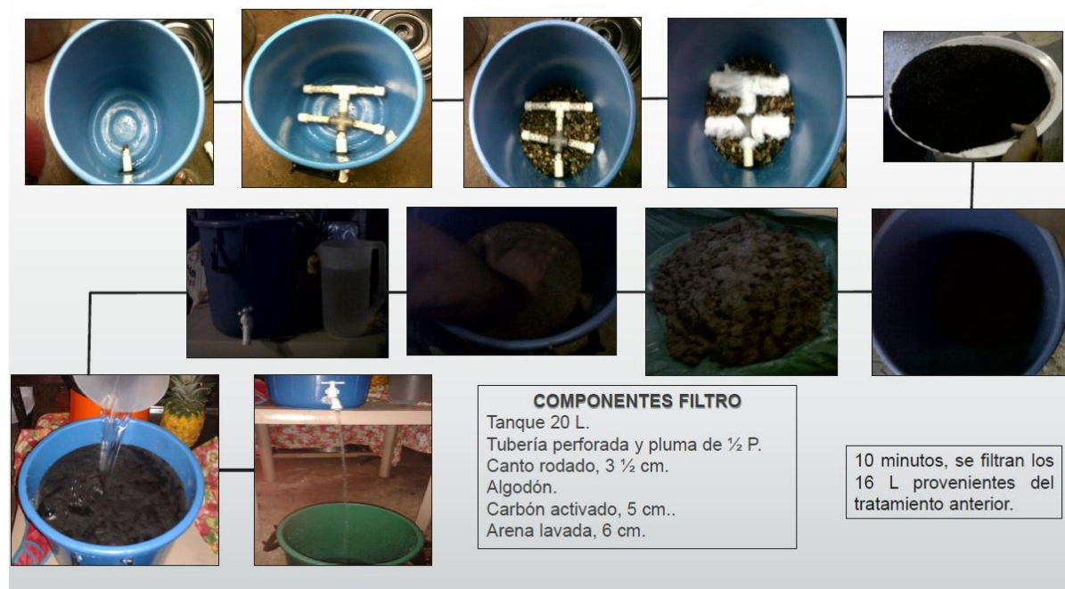
Figura 2: Construcción del sistema de filtración
