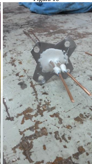
Novo passador elétrico; Montagem do novo passador elétrico no reator.
