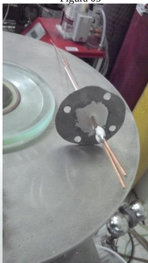
Novo passador elétrico; Montagem do novo passador elétrico no reator.
