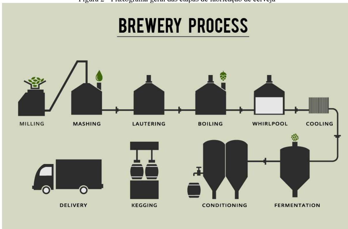
Figura 2 - Fluxograma geral das etapas de fabricação de cerveja
