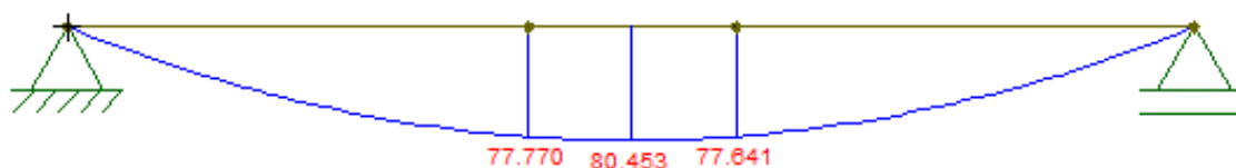
Figura 60 - Transversina: momento da carga fixa
