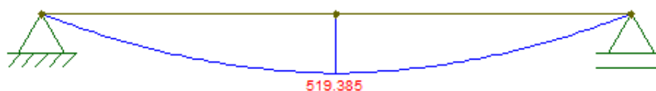
Figura 46 - Longarina: momento da carga fixa
